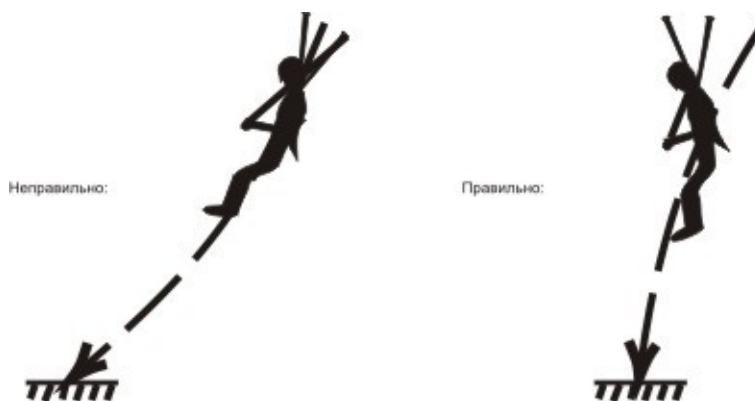
Рисунок 13 - Подгонка подвесной системы
