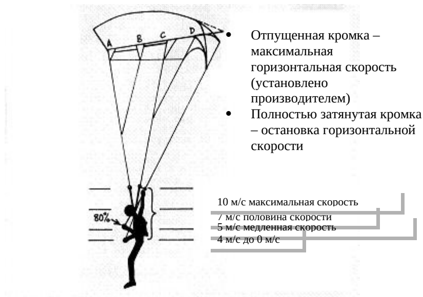
Рисунок 12 - Изменение горизонтальной составляющей скорости снижения
